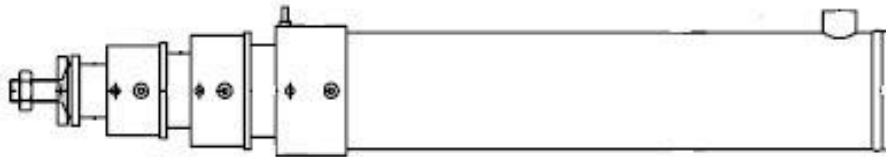
شکل ۲: شماتیک جک تلسکوپی
