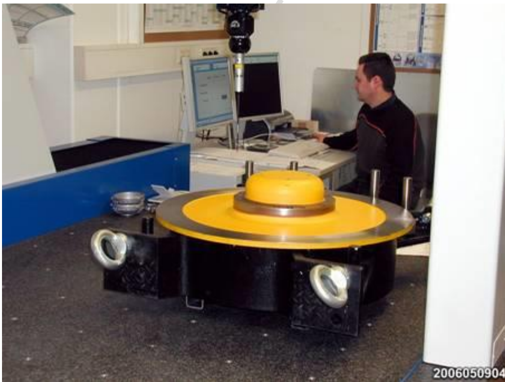
شکل ۶۴: اندازه‌گیری سه‌بعدی قطعات
