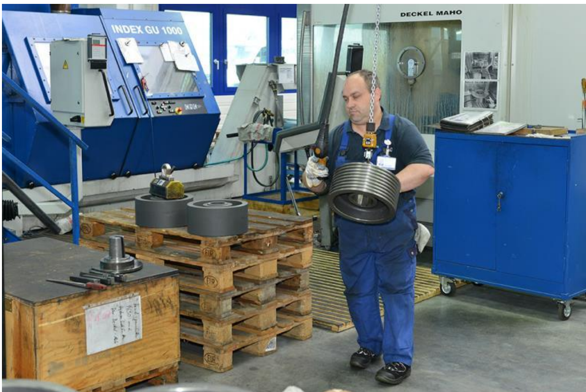
شکل ۵۲: خط تولید - ساخت فلکه کشش
